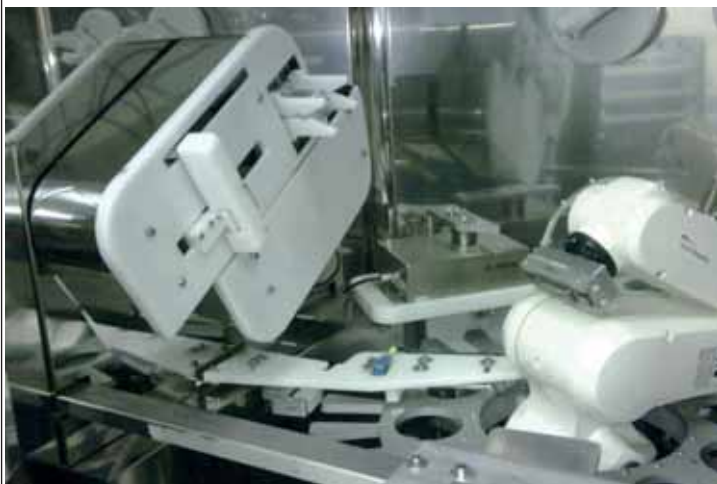
All'operatore viene richiesto solo di caricare i materiali necessari (farmaci, siringhe e sacche) e di ritirare le preparazioni al termine delle operazioni.
